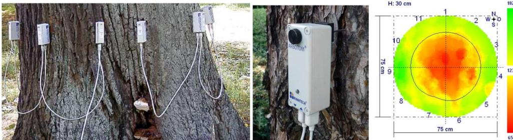
**Principe de fonctionnement du tomographe à ondes sonores (exemple hors étude). A. disposition des capteurs autour du tronc. B. capteur. C. Tomogramme coloré correspondant. Les couleurs correspondent à différentes vitesses de propagation du son au travers de l'arbre, corrélées à la densité du bois. Sur ce tomogramme, la zone rouge correspond à une pourriture interne.**
