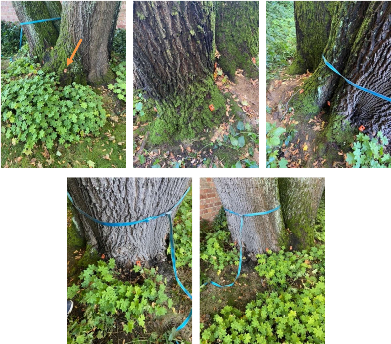
Figure 7 : position du tomographe à ondes sonores en fonction de la présence de la fourche basale
